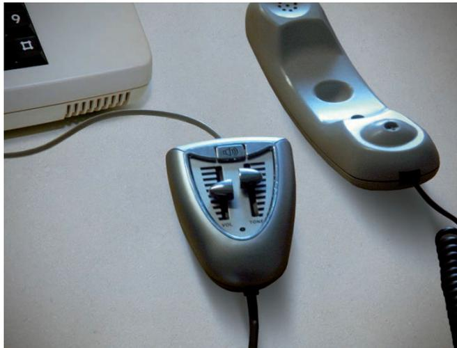
Der **PL-51** verfügt über eine Zusatzverstärkung: Bei gedrückter Verstärkertaste verdoppelt er die eingestellte Lautstärke.
